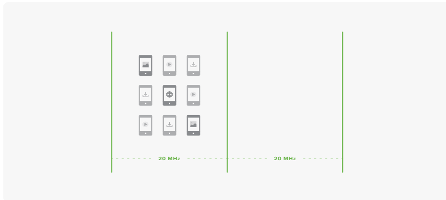
Schéma 6. Neuf unités de ressources (RU) dans un seul canal de 20 MHz
